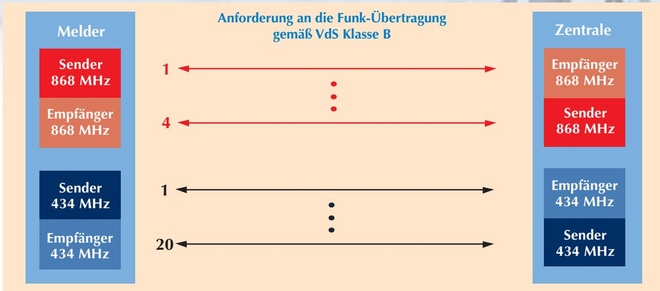
*DynaBand*<sup>®</sup> bezeichnet das bei Daitem D24000 patentierte Funk-Übertragungsverfahren, das sich *dynamisch* den Übertragungsbedingungen anpasst und den jeweils geeignetsten Funk-Übertragungskanal auswählt.
