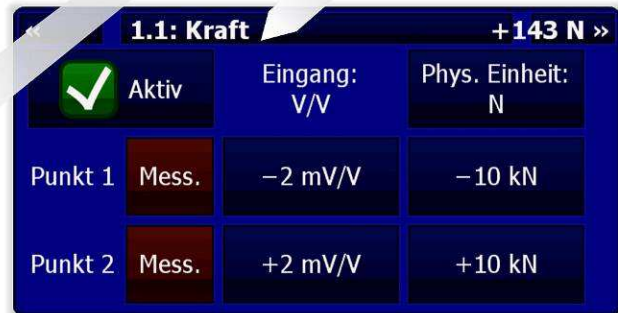
Parameter eines 10 kN Kraftaufnehmers
