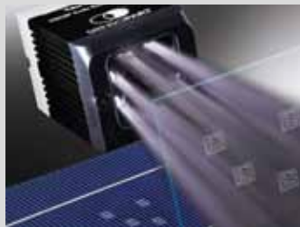
Codelesung auf Solarzellen Optik und Beleuchtungsvarianten ermöglichen die optimale Anpassung an nahezu jede Applikation. Auch extrem klein gedruckte Codes können gelesen werden.
