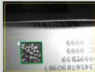
Gedruckte Codes auf Pharma-Verpackungen Es kann zeitgleich nach ECC200 oder Barcodes (z. B. EAN 13) gesucht werden. Neben der Codelesung kann per Objekterkennung die Anwesenheit des Klartextes geprüft werden.
