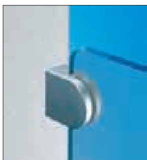
Wandplattenhalter NT.408 zur Klemmen der bauseitigen Füllungen bis 12 mm Dicke, an Pfosten Ø 40 mm, verdeckte Verschraubung.
