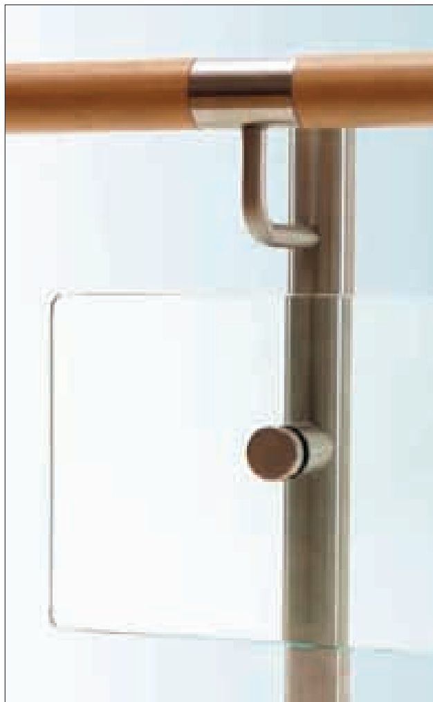
Plattenhalter NT.406 zum Klemmen der bauseitigen Füllungen bis 12 mm Dicke, an Pfosten Ø 40 mm, verdeckte Verschraubung.
