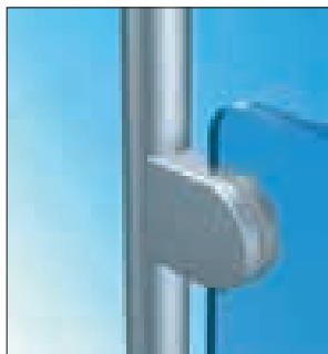
Plattenhalter NT.406 zum Klemmen der bauseitigen Füllungen bis 12 mm Dicke, an Pfosten Ø 40 mm, verdeckte Verschraubung.
