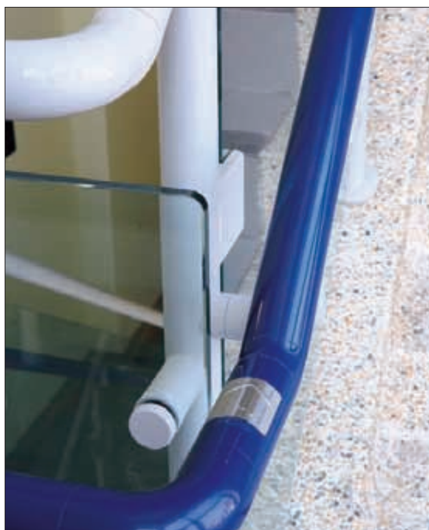
Vorgesetzter Plattenhalter NT.410 zur Verschraubung der vorgesetzten bauseitigen Füllungen, an Pfosten Ø 40 mm, verdeckte Verschraubung.
