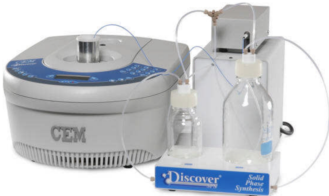
Abb. 1: CEM Discover mit Spezialausrüstung für die Festphasen-Peptid-Synthese nach Merrifield
