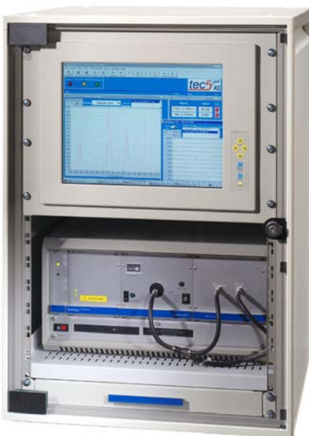
Schichtdickenmessungen im Prozess mit der MultiSpec -Serie
