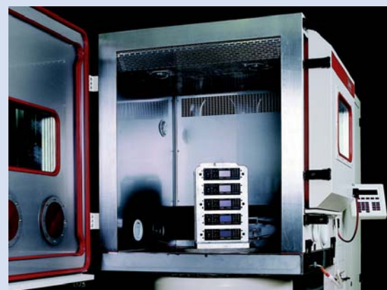
Kombinierte Klima- und Vibrationsprüfung von Autoradios, Blaupunkt GmbH, Hildesheim
