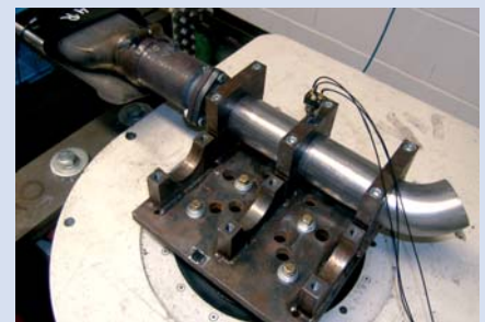
Prüfung von Abgasanlagen bei ArvinMeritor Emissions Technologies GmbH in Augsburg
