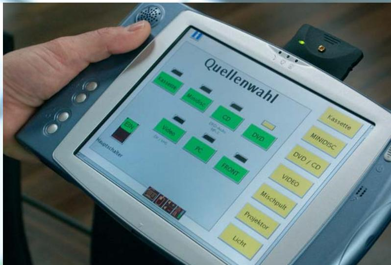
**Zahlreiche Einsatzmöglichkeiten:** Die CoDeSys Visualisierung zur Maschinen-Bedienung, Fernwartung, Diagnose und Inbetriebnahme.
