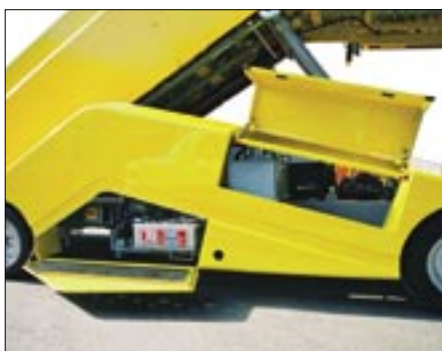
Einfache und leichte Servicearbeiten durch weit öffnende Wartungsklappen.
